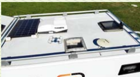
▲ Klimatyzacja dachowa, panel solarny, antena DVB-T – tu jest wszystko
